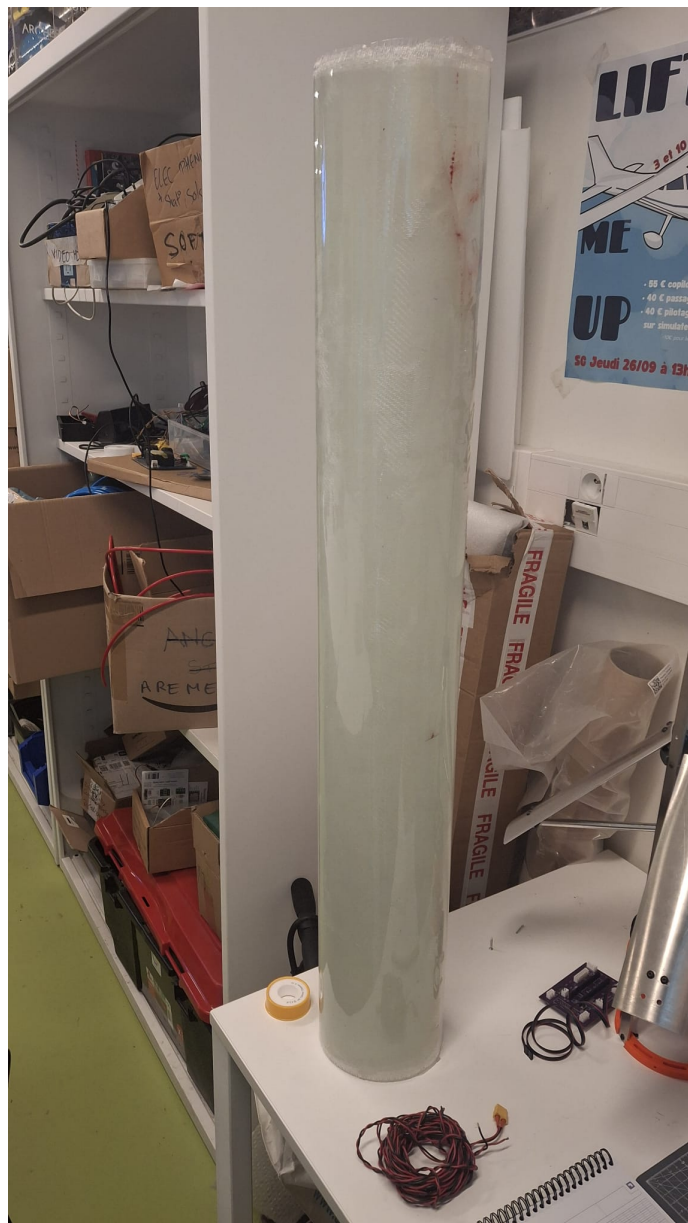
FIGURE 2.16 – Photo d'un prototype de tube en fibre de verre
