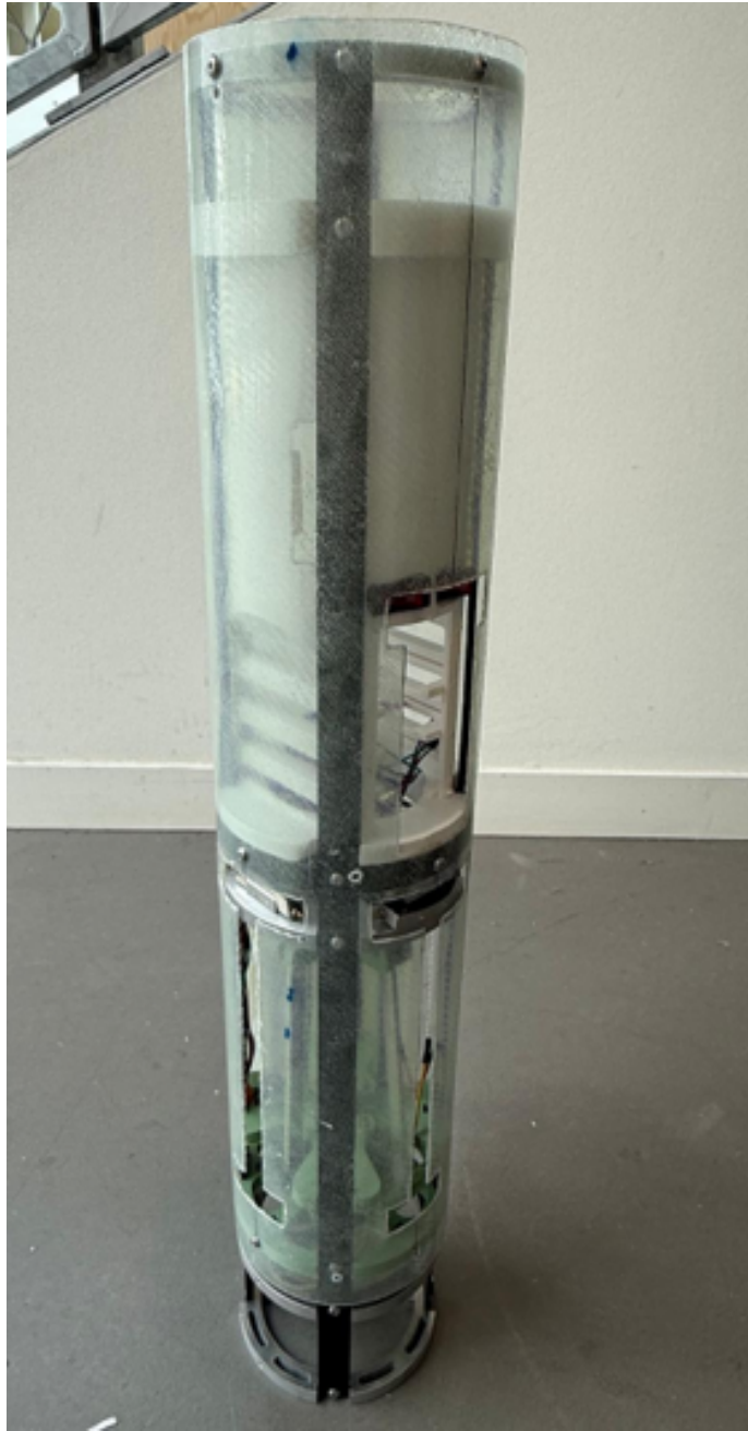
FIGURE 2.20 – Photo du tube en fibre de verre post-intégration
