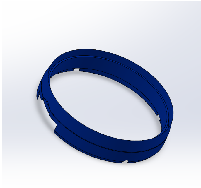
FIGURE 2.21 – CAO de la bague de jonction des deux tubes
