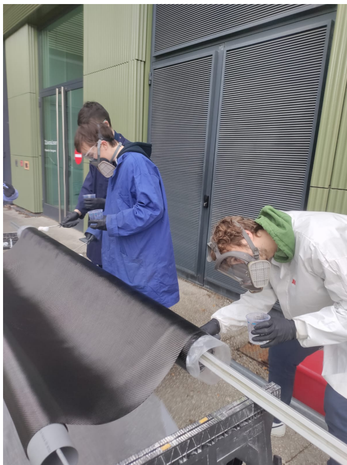
FIGURE 2.17 – Photo du procédé d'usinage du tube
